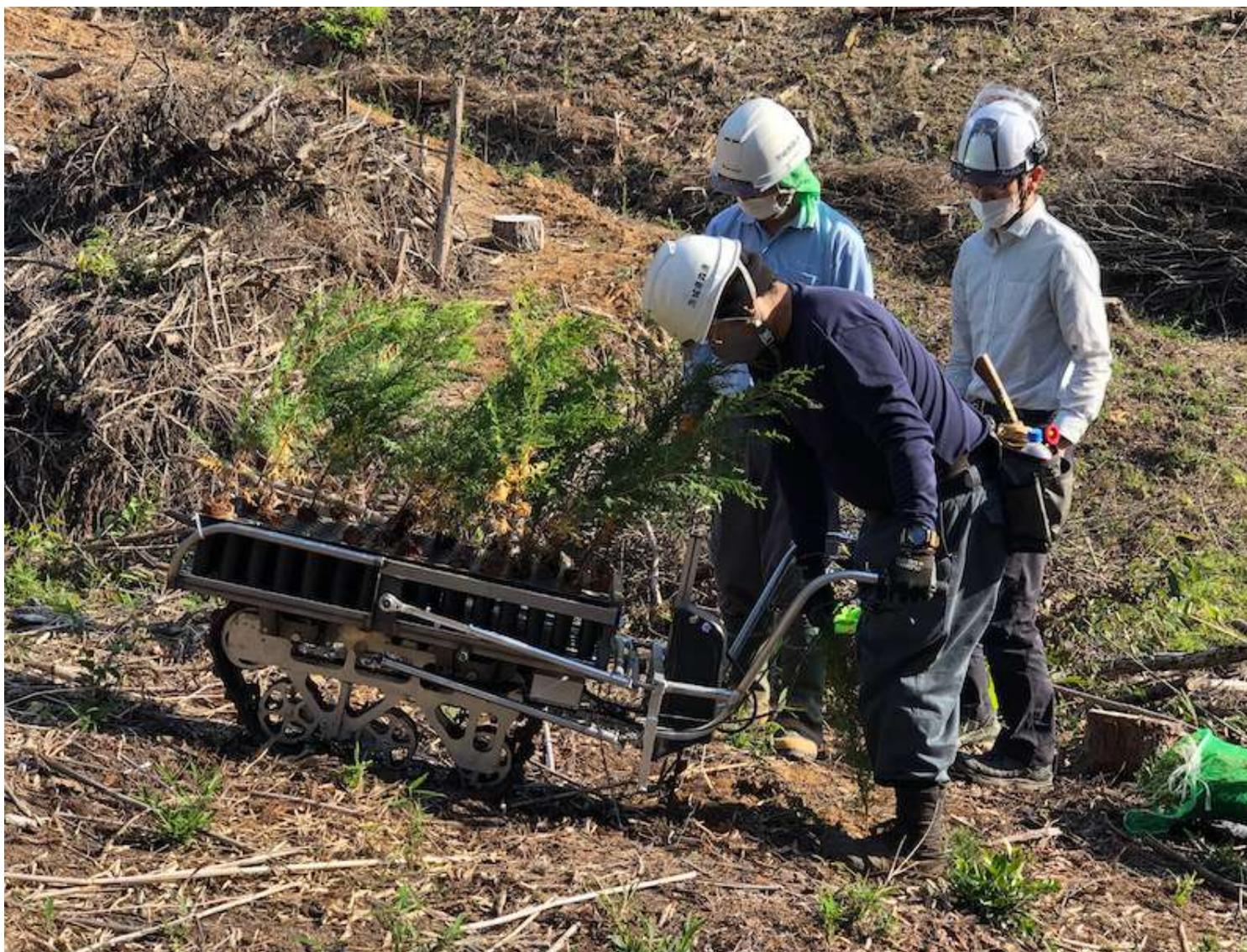
28 植栽用の電動クローラ型一輪車
